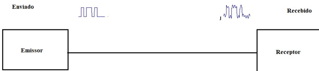
*Figura 11: Interferência pelo uso de outro sinal com bandas de frequência próximas.*
