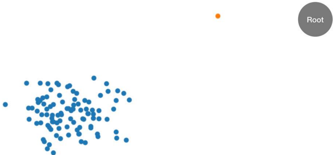
Figura 6 - Conjunto de dados bidimensionais recebido onde é possível observar que a maioria dos dados estão agrupados (azul), exceto um conjunto de dados que está mais afastado (laranja). A árvore é inicializada com um nó raiz. [20]
