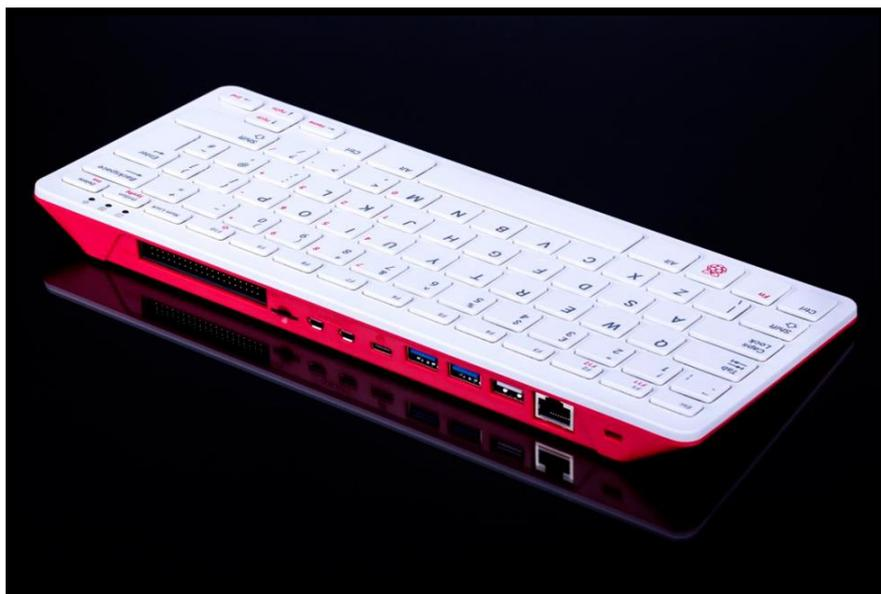
Figura 3- Raspberry Pi 400 integrado diretamente num teclado
